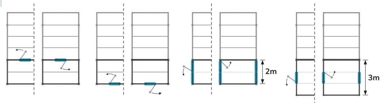
La porte peut être installée avec la poignée à gauche (ouverture vers l'extérieur) ou avec la poignée à droite (ouverture vers l'intérieur).
